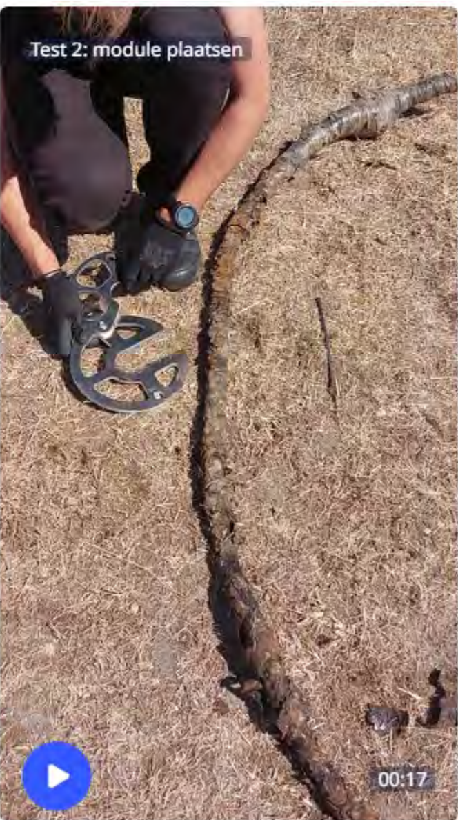
Video 2: Plaatsen van 10mm dikke module, met ruimte onder de kabel.
