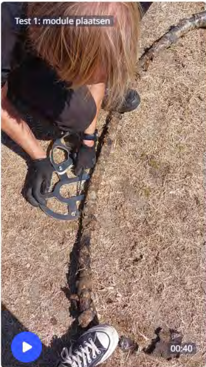
Video 1: Plaatsen van 10mm dikke module, als deze erg strak op de grond zit, zonder vrijgraven
