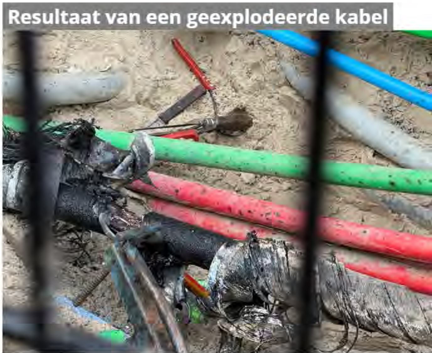
Video 6: Explosie van een MS kabel
