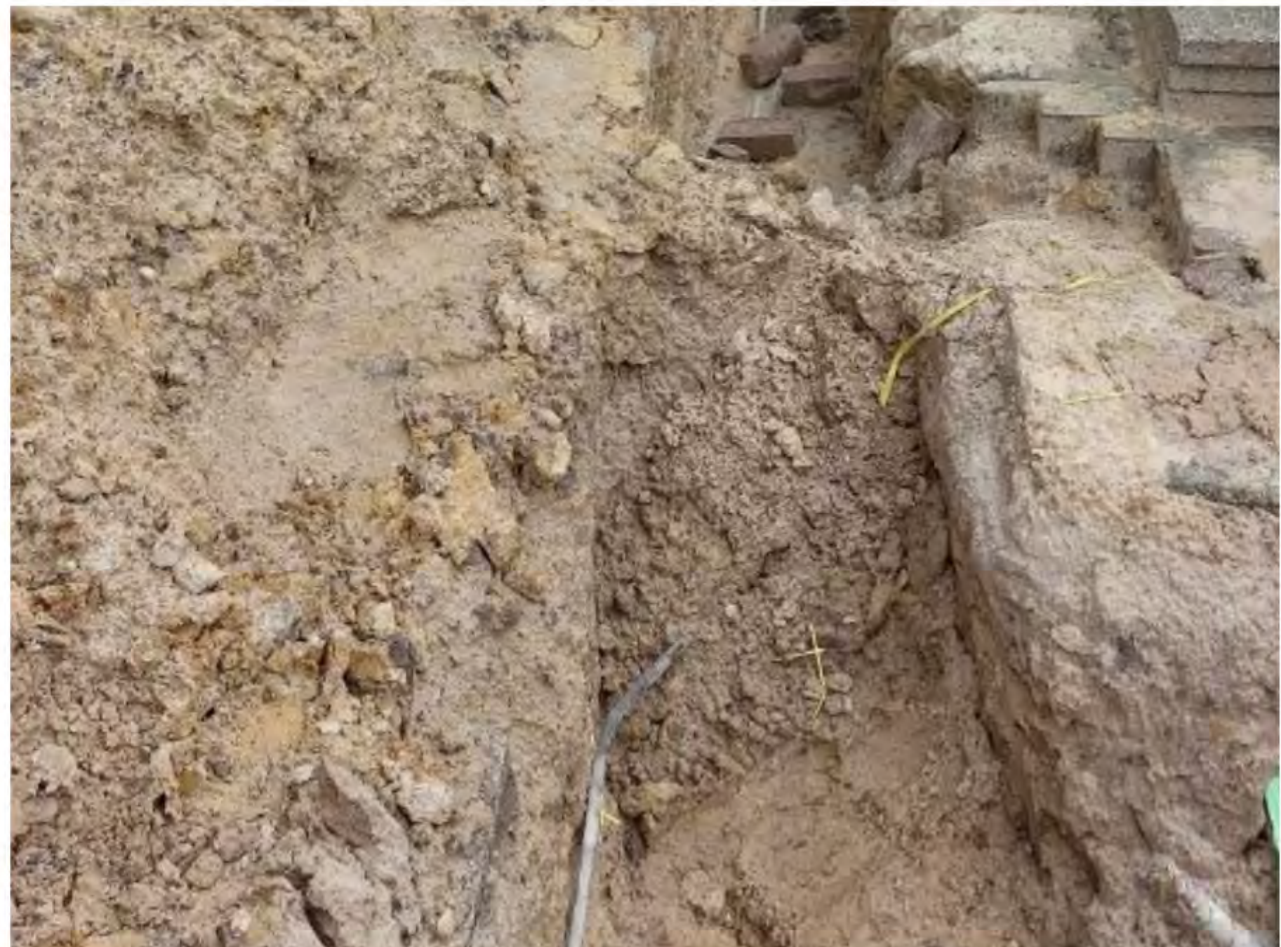
Het instorten van de geul gebeurt regelmatig en zorgt er voor dat de modules uit het zicht verdwijnen. Afhankelijk van het uiteindelijke ontwerp van de module zal er zand binnen dringen.
