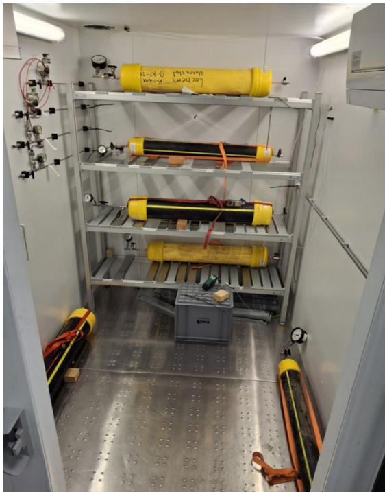
Figuur 11 - Meetopstelling uitgenomen leidingdelen bij Kiwa
